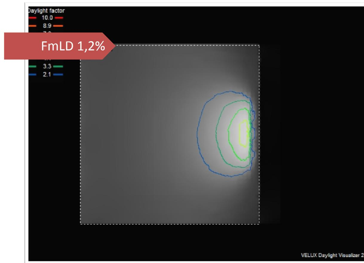
Muro + 20cm cappotto + vetro triplo bassoemissivo e selettivo + protezione solare fissa
